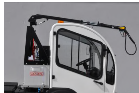
HP 200 l i 130 bar + perxa, entre cabina i caixa
