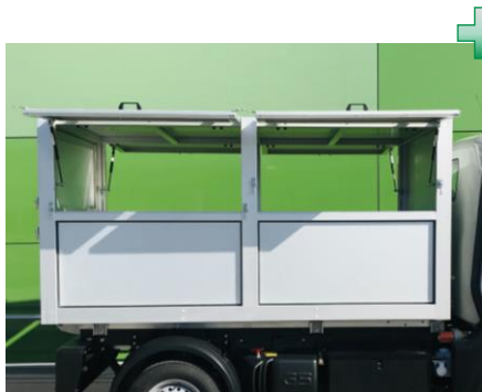
Caixa basculant amb finestres abatibles 1/2/3 f.
