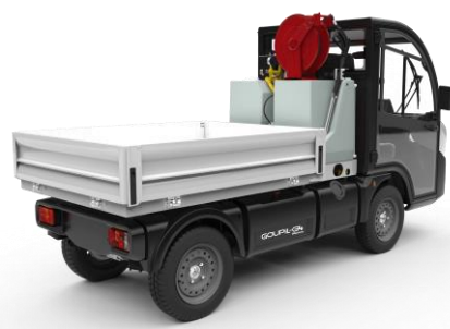
HP 200 l i 200 bar, entre cabina i caixa
